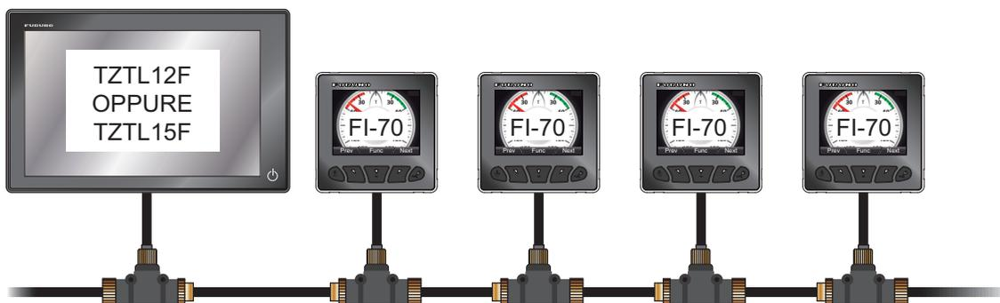
La rete NMEA può contenere una o più unità FI-70 o altre apparecchiature. Nell'esempio precedente, la rete contiene un'unità TZtouch2 e quattro unità FI-70.
