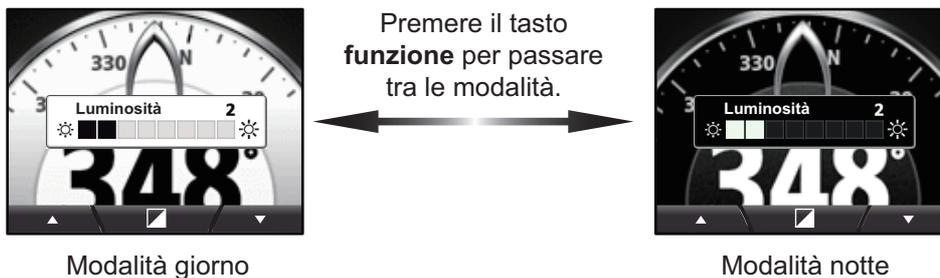
**Nota:** Se l'unità FI-70 è soggetta a calore ingiustificato, la luminosità potrebbe ridursi automaticamente. Ciò consente di evitare il surriscaldamento e non è indice di malfunzionamento.
